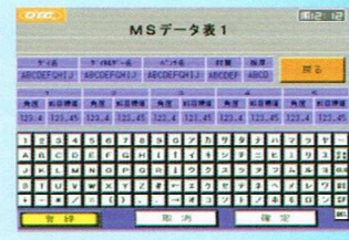
■MS曲げ角度データモード (曲げ登録データを自動で表示)
